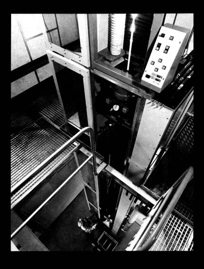
Neuer Ziehturm mit einer Produktionskapazität von 100 m Faser pro Minute
