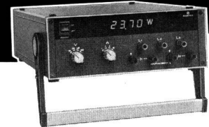
D-4155 Präzisions-Wattmeter für Einphasen- und Drehstrom-Systeme, 28 000 Digit, Genauigkeit \pm 0,1\%
