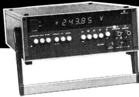
D-4025 / D-4045 System-Multimeter mit hoher Auflösung 28 500 Digit, rms oder true-rms, autoranging
