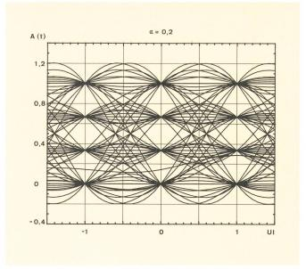
Fig. 8 Augendiagramm 16 QAM
