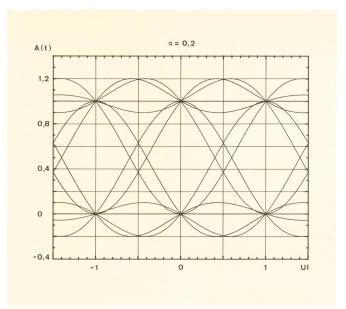
Fig. 6 Augendiagramm 4 PSK/4 QAM
