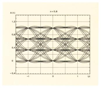
Fig. 9 Augendiagramm 16 QAM
