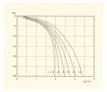
Fig. 11 Nebenkanaldämpfung am Regenerator
