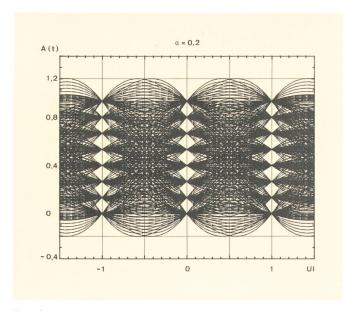
Fig. 10 Augendiagramm 64 QAM
