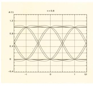
Fig. 7 Augendiagramm 4 PSK/4 QAM
