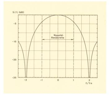
Fig. 1 PSK/QAM-Spektrum (ohne Filter)
