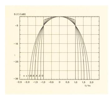
Fig. 3 PSK- und QAM-Leistungsspektren (Senderausgang)
