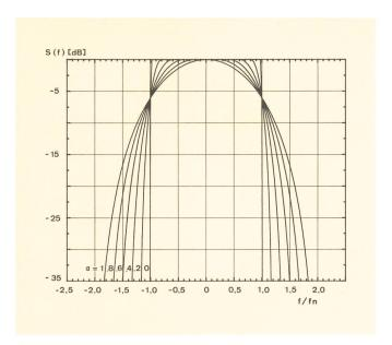
Fig. 2 PSK- und QAM-Leistungsspektren (am Regenerator)
