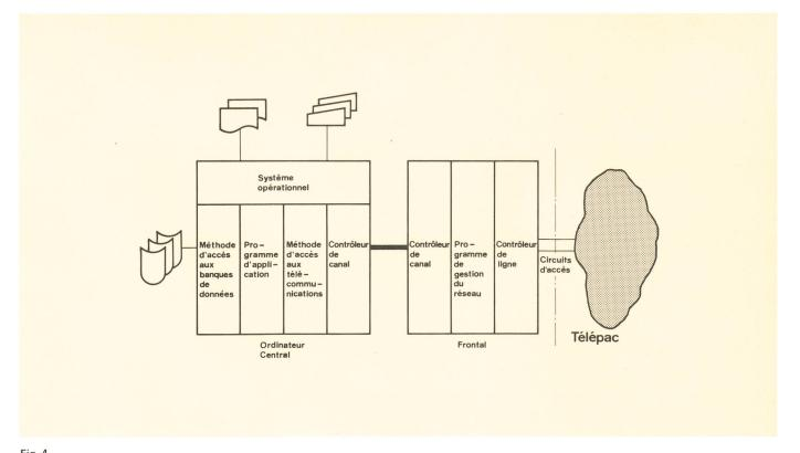
Fig. 4 Typische Softwarestruktur für die Datenübertragung Système opérationnel - Betriebssystem
