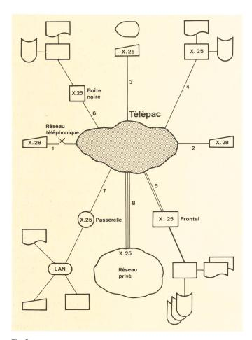
Fig. 3 Überblick über Teilnehmereinrichtungen, die an Telepac angeschlossen werden können
