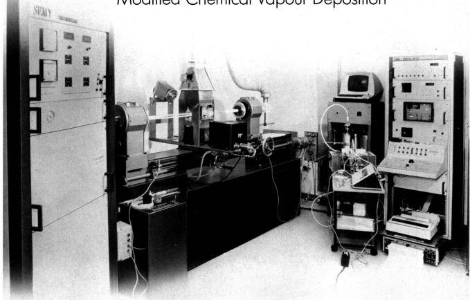
MCVD est l'abréviation du procédé utilisé par CABLOPTIC pour produire industriellement des fibres optiques.
