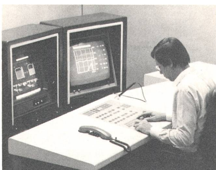
Fig. 5 Modulares Terminal und Bediensystem für die Mensch-Prozessrechner-Kommunikation
