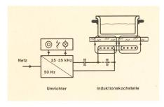
Fig. 9 Prinzipieller Aufbau eines Induktions-Kochgerätes
