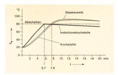
Fig. 10 Zeitlicher Temperaturverlauf beim Erwärmen von 2 l Wasser von 20 °C mit 1800 W mit herkömmlicher Kochplatte, Glaskeramikplatte und Induktionskochstelle
