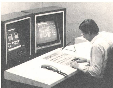
Fig. 5 Modulares Terminal und Bediensystem für die Mensch-Prozessrechner-Kommunikation
