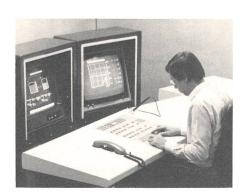
Fig. 5 Modulares Terminal und Bediensystem für die Mensch-Prozessrechner-Kommunikation
