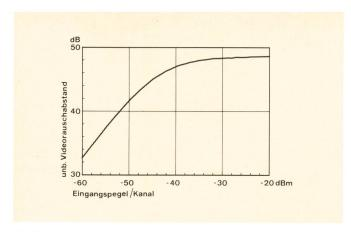
Fig. 5 Videorauschabstand in Funktion des Kanalpegels
