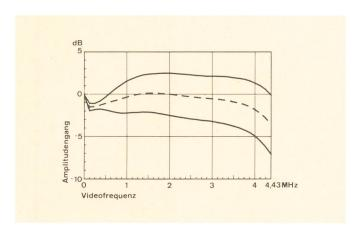
Fig. 3 Streubereich des videofrequenten Amplitudenfrequenzgangs
