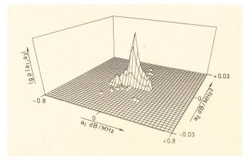
Fig. 2 Density function of the coefficients of the fit-polynomial — Dichtefunktion der Koeffizienten des Approximationspolynoms Attenuation — Dämpfung (f) =  $a_0 + a_1 \cdot f + a_2 \cdot f^2$  (839610 Sweeps) 5 dB >  $a_0 \ge -45$  dB May 1981 to February 1982 — Mai 1981 bis Februar 1982 With space diversity — Mit Raumdiversityempfang
