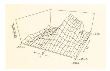
Fig. 10 Correlation-matrix of group-delay vs attenuation — Korrelations-matrix von Gruppenlaufzeit und Schwundtiefe Values at f=0 — Werte bei f=0
