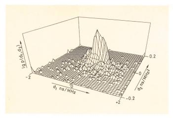
Fig. 5 Density function of the coefficients of the fit-polynomial — Dichtefunktion der Koeffizienten des Approximationspolynoms Group delay — Gruppenlaufzeit (f) =  $d_0 + d_1 \cdot f + f \ d_2 \cdot f^2$  (1101433 Sweeps) —55 ns >  $d_0 \ge 55$  ns March 1981 to February 1982 — März 1981 bis Februar 1982 Without diversity — Ohne Raumdiversityempfang
