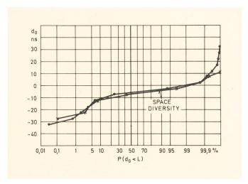
Fig. 7 Group delay — Gruppenlaufzeit Distribution function of the coefficient  $d_0$  of the fit-polynomial — Verteilungsfunktion des Koeffizienten  $d_0$  des Approximationspolynoms D  $(f) = d_0 + d_1 f + d_2 f^2$  Space diversity — Raumdiversityempfang
