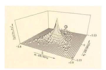
Fig. 1 Density function of the coefficients of the fit-polynomial — Dichtefunktion der Koeffizienten des Approximationspolynoms Attenuation — Dämpfung (f) =  $a_0 + a_1 \cdot f + a_2 \cdot f^2$  (1193785 Sweeps) 5 dB >  $a_0 \ge -45$  dB March 1981 to February 1982 — März 1981 bis Februar 1982 Without space diversity — Ohne Raumdiversityempfang
