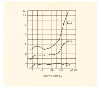
Fig. 11 Correlation group-delay vs fade depth - Korrelation von Gruppen-laufzeit und Schwundtiefe Coefficient  $a_0$  — Koeffizient  $a_0$
