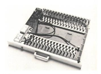
Fig. 8 Schaltmatrix mit Reedrelais für die Programmdurchschaltung
