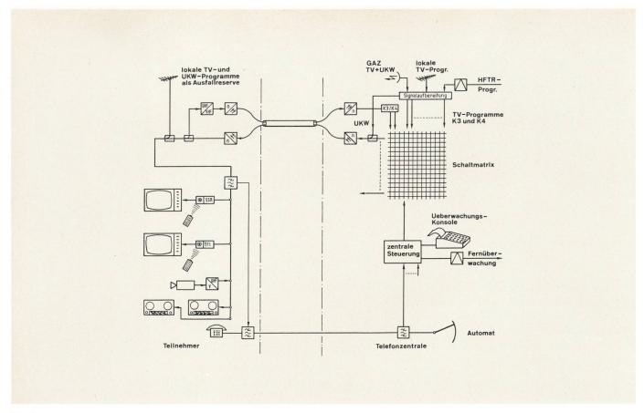
Fig. 6 Prinzipskizze der Breitbandkommunikation-Pilotanlage
