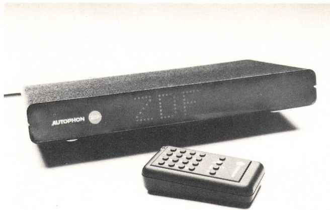
Fig. 7 Infrarotfernsteuerung beim Teilnehmer mit Sender und Empfänger
