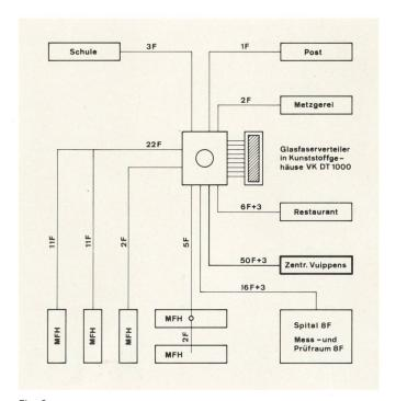
Fig. 3 Aufbau der Kabelanlage
