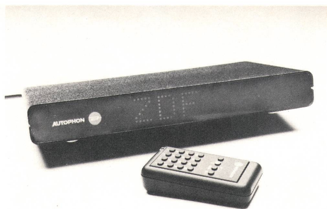
Fig. 7 Infrarotfernsteuerung beim Teilnehmer mit Sender und Empfänger
