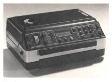
Fig. 9 Magnétoscope portable 1" format B
