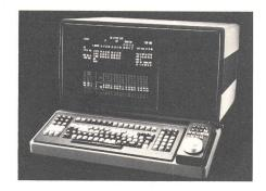
Fig. 12 Console pour système de montage CMX 3400 +, commandée par ordinateur
