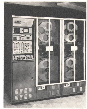
Fig. 13 Télécinéma à CCD équipé de deux projecteurs (système multiplexe) de Rank Cintel
