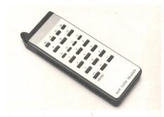
Fig. 2 Kombination Balkenleser mit Infrarotfernsteuerung
