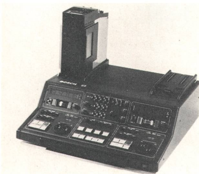
Fig. 8 Dispositif de montage pour le système Quatercam utilisant le magnétoscope de la caméra comme transport de bande
