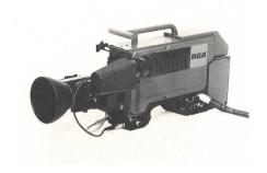
Fig. 1 Tête de caméra portable TKP 47 de la famille TK 47B, de RCA
