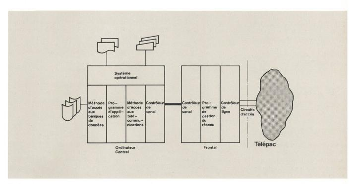
Fig. 4 Structure typique de logiciel d'accès
