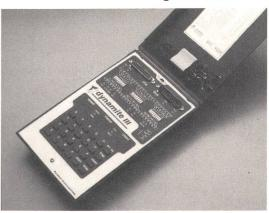
Über wenige Tasten geben Sie alle Parameter zum Testen Ihres Datenkommunikations-Systems ein. Und auf Abruf wird DynaMite III sequenziell alle ausgewählten Testparameter, sogar mit Ihrem eigenen 64-Zeichen-Testprogramm, anzeigen:
