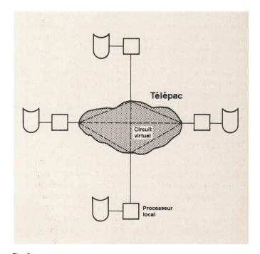
Fig. 3 Télépac et les applications décentralisées
