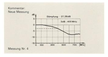
Fig. 8 Grafische Darstellung der Dämpfung eines Glasfaserkabels
