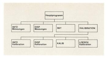
Fig. 13 Blockdiagramm des Programmes auf der Kalibrationskassette
