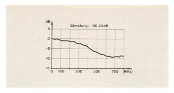
Fig. 7 Grafische Darstellung der Dämpfung der Messanlage mit Glasfaserkabel. Der ausgegebene Dämpfungswert bezieht sich auf die tiefste Messfrequenz (0 Hz)
