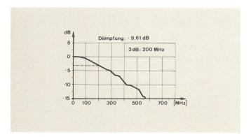
Fig. 12 Einzelfasermessung in Altdorf
