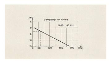
Fig. 15 Grafische Darstellung der Dämpfung des Messobjektes
