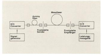
Fig. 1 Messplatz mit Messgerät für die elektrische Leistung
