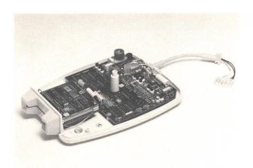
Fig. 2 Kartenleseruntersatz mit entferntem Gehäuseoberteil
