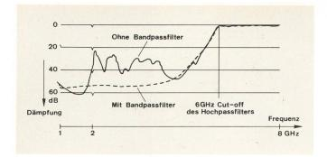
Fig. 18 Einfügungsdämpfung eines Hochpassfilters
