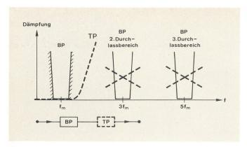
Fig. 8 Funktion der Tiefpassfilter
