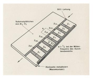
Fig. 6 Bandpassfilter mit  $\lambda/4$ -Leitungselementen in Streifenleitungstechnik
