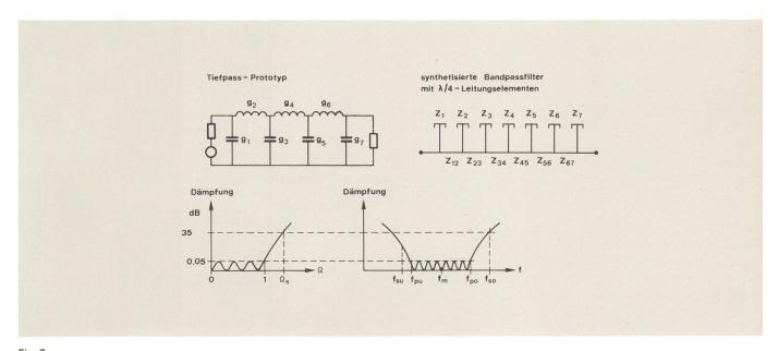
Fig. 7 Tiefpass-Bandpass-Transformation: Tiefpassprototyp und synthetisiertes Bandpassfilter mit kurzgeschlossenen  $\lambda$ /4-Stichleitungen
