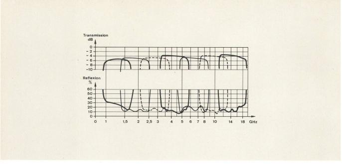
Fig. 13 Filterkurven vor Einbau in Gehäuse
