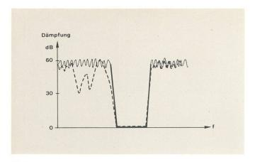
Fig. 2 Einfluss von Generator-Oberwellen auf die Messung eines Bandpassfilters (Messung mit Diodendetektoren)
