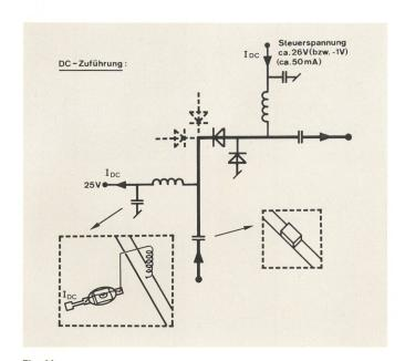
Fig. 11 Zuführung der Schalter-Steuerströme
