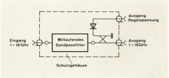
Fig. 15 Schema und Ausführung des fertigen Filters
