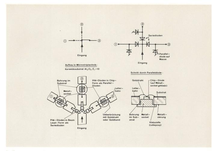
Fig. 10 Aufbau der PIN-Dioden-Schalter
