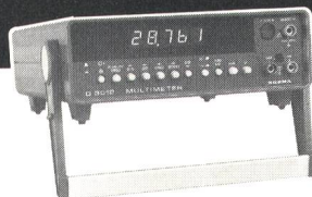
D-3012 Hochgenaues Digital-Multimeter, 28 000 Digit LED, Messbereiche bis 2 kV/20 A, BCD-Ausgang (Option)
