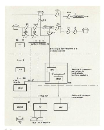
Fig. 7 Struttura del sistema HS 52 B
