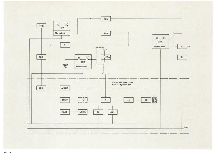
Schema a blocchi di una centrale urbana Pentaconta e circuiti sostituiti dal registro SPC
