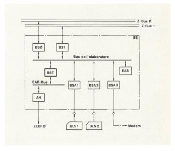
Fig. 6 Unità di servizio A 52 S/HS 52 B AN Circuito di connessione
