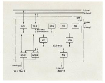
Fig. 4 Dispositivo d'identificazione A 52 S/HS 52 B CAN-Bus Bus di connessione del codificatore
