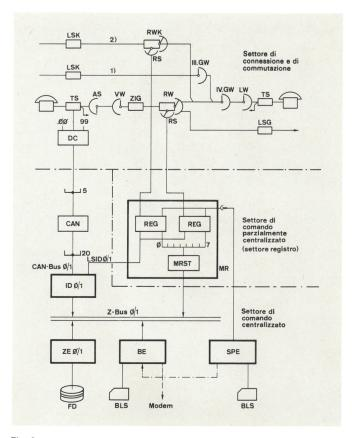
Fig. 1 Struttura del sistema A 52 S
