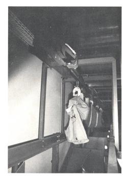
Fig. 6 Vue du transporteur à chaîne avec des pinces à sacs chargées passant au-dessus des entrées des glissières de stockage
