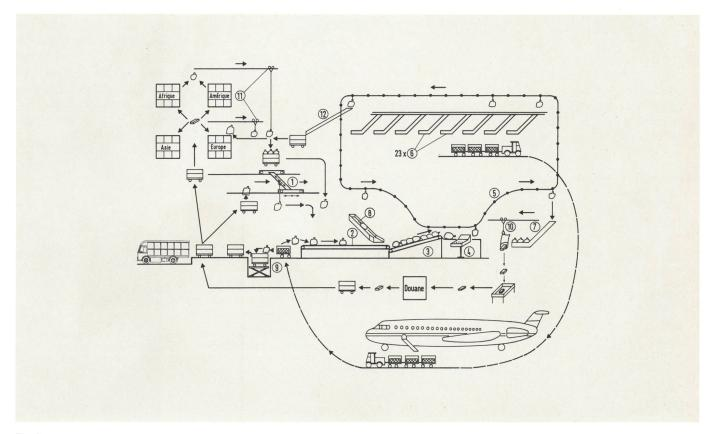
Fig. 4 Représentation schématique du tri des sacs
