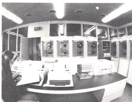
Betriebsraum mit Konsole und Magnetbandstationen
