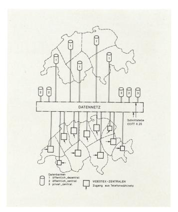
Fig. 11 Langfristige Lösung zur Verwirklichung des Videotex-Dienstes
