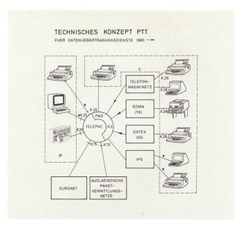
Fig. 10 Zusammenfassende Darstellung des PTT-Konzeptes für die Datenübermittlung
