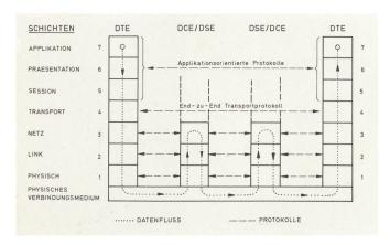
Fig. 5 Schichtmodell ISO/OSI (OSI = Open Systems Interconnection) bzw. CCITT, angewendet auf ein Datennetz nach Bild 3
