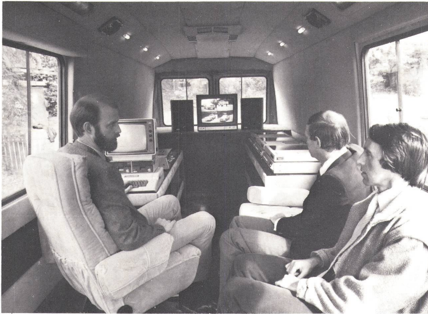
Fig. 1 In diesem fahrbaren Vorführraum wird bis zu fünf Personen Gelegenheit zu einer computergesteuerten Bildplattenvorführung an ihrem eigenen Standort geboten. Das Infomobil verfügt über eine eigene Stromanlage und ist mit einer Multi-Player-Ausrüstung ausgestattet.
