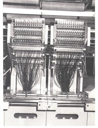
Fig. 4 Automatische Bestükkungsmaschine, die in wenigen Sekunden gleichzeitig mehrere Hundert Bauelemente auf dem Chassis plaziert. Der Elementevorrat befindet sich in den oben sichtbaren Behältern, von wo die ein-Bauelemente zelnen pneumatisch über Schlauchleitungen an den vorbestimmten Platz auf der Platine gelangen
