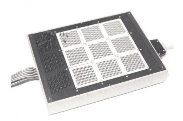
Fig. 5 Steckbarer Kreuzschienenverteiler
