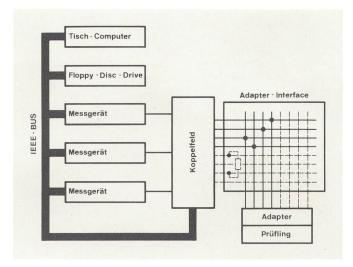
Fig. 1 Blockschaltbild des computergesteuerten Messplatzes
