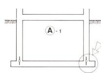
Pas de «cuvelage» nécessaire. Les adjuvants d'étanchéité sont mélangés au béton plastique. Il y a lieu d'observer scrupuleusement les prescriptions des fournisseurs.
