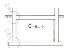
Ce mode d'étanchéité, à savoir l'application *intérieure* d'une couche élastique, est souvent utilisé pour les assainissements. Lorsque le niveau de la nappe phréatique est bas, ce système se révèle efficace. En revanche, lorsque la pression de l'eau d'accumulation est forte, les risques de déconvenues sont élevés.
