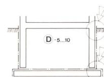
Le système d'étanchéité extérieur «classique», sans cuvelage, est la méthode la plus courante, bien qu'il y ait un risque de mise en danger mécanique élevé de l'étanchéité pendant la construction, particulièrement pour le système D.
