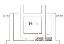
Wie bei den Systemen F und G sind auch bei H die Wände durch einen Gang getrennt, wobei der Boden vom Wannenboden abgehoben ist (Hohlboden). Der Raum dazwischen kann hohl bleiben oder mit Grobkies ausgefüllt werden. Die Entwässerung dieses Hohrraumes ist sicherzustellen. Da dieses System mit der Abdichtung 1
