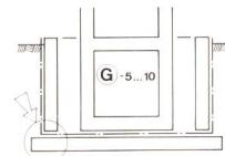
Le système G ressemble au système F, sauf en ce qui concerne l'étanchéité des parois. Dans ce cas, celles-ci sont également rendues étanches avec un matériau souple (fig. 14 et 15).
