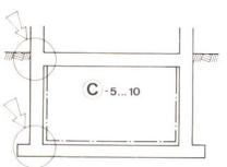
Diese Abdichtungsart, nämlich *innen* eine elastische Schicht, wird vielfach für Sanierungen angewendet. Für einen niedrigen Grundwasserspiegel ist dieses System wir-
