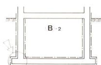
B-2a (Dünnschichtputz aussen), auch Schlemmputz genannt. Da der Verputz nur auf einer rauhen und griffigen sowie nicht öligen Oberfläche haftet und zudem besondere Kenntnisse beim Applizieren verlangt, ist das System für Grossbauten weniger üblich, obwohl eine Sanierung allfällig feuchter Stellen einfach und billig wäre.
