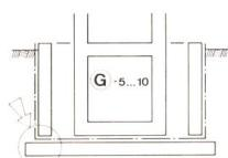
Das G-System ist dem System F ähnlich, mit Ausnahme der Wandabdichtung. Hier wird ebenfalls die Wannenwand elastisch abgedichtet.
