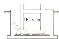
Au niveau du sol, le système F prévoit une étanchéité souple et une étanchéité rigide dans la région des parois. L'eau qui pourrait éventuellement pénétrer à travers les parois du cuvelage est recueillie dans la fouille (galerie de contrôle) puis évacuée dans la canalisation (puisard de pompe).
