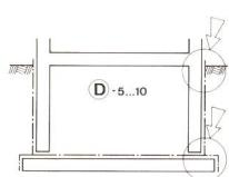
Diese «klassische» Aussenabdichtung ohne Wanne wird am meisten ausgeführt, obwohl während des Baus besonders bei System D die Abdichtung mechanisch stark gefährdet ist.
