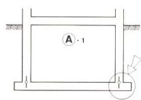
Keine «Wanne» notwendig. Der Abdichtungszusatz wird im plastischen Beton eingemischt. Die einschlägigen Vorschriften der Lieferanten sind genaugestens zu befolgen. Aussparungen sind nachträglich speziell zu dichten. Vor dem Hinterfüllen sollte die Grube mit Wasser gefüllt werden (Achtung: nicht zu früh, wegen Aufschwimmens des Gebäudes), um Undichtigkeiten in den Wänden rechtzeitig festzustellen. Abgedichtet wird meist mit gezielten Injektionen.
