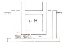
Comme les systèmes F et G, le système H consiste en parois séparées par une galerie, la dalle de fond étant distante de la dalle du cuvelage (vide). Cet espace peut rester vide ou être comblé avec du gros gravier. Il importe que le drainage de ce vide soit assuré. Etant donné que ce système est réalisé avec l'étanchéité 1, il n'est pas nécessaire d'appliquer une étanchéité souple proprement dite (sécurité!). Soit dit en passant, cette méthode est encore plus sûre que les systèmes F et G.
