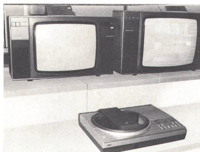
Fig. 13 Spieler für die laserabgetastete Bildplatte VLP
