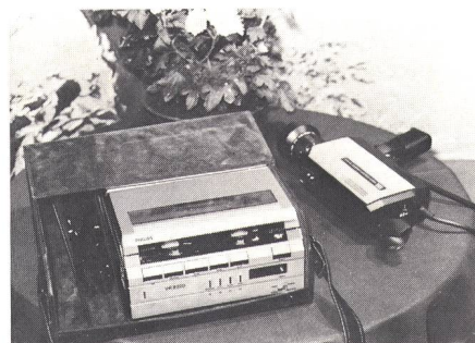
Fig. 9 Tragbarer Videorecorder des Systems 2000 mit Farbkamera zum elektronischen Filmen
