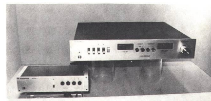
Fig. 3 Links der CX-, rechts der High-Com-Baustein von Telefunken für nachträgliche Einfügung in Hi-Fi-Anlagen
