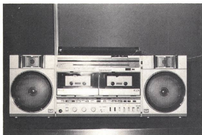
Fig. 1 Stereo-Kassetten-Kofferradio mit Zwei-kassettenlaufwerk zum Überspielen oder pausenlosen Kassettenbetrieb
