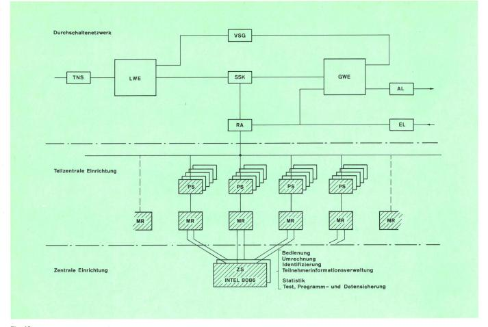
Fig. 10 Schéma bloc d'un central local Pentaconta avec enregistreur SPC (commande par programme enregistré, PC 85)
