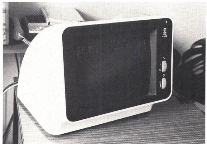
Fig. 15 Monitor TVT 6060. Original Terco-Monitor mit Gehäuse im Aufenthaltsraum einer Mehrzweckanlage. Eine Bedienungskonsole mit Hupe und Quittiertaste wird separat plaziert — Moniteur TVT 6060. Moniteur Terco original avec boîtier situé dans un local de séjour d'une installation à usages multiples. Une console de desserte avec klaxon et touche de quittance est placée séparément
