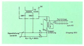
Fig. 10 Anordnung zur Messung der asymmetrischen Störspannungen Kopplungsschaltung:
