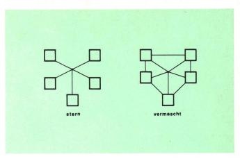
Fig. 3 Systemverbindungsart
