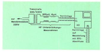
Fig. 8 Netzanschluss für Oszilloskope [4]
