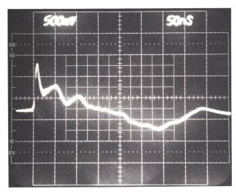
Fig. 12 Störspannung  $U_1$  an der Störquelle (Anschluss gemäss Fig. 11)
