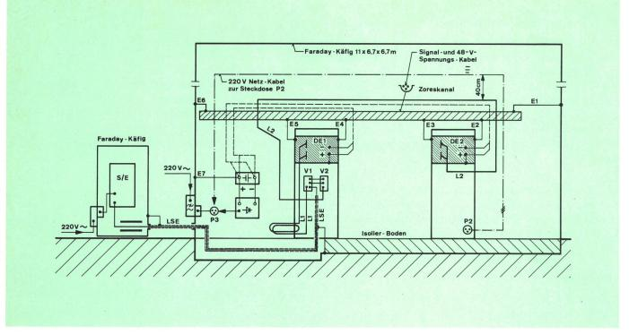
Fig. 1 Versuchsaufbau mit zwei IFS-Durchschalteeinheiten (DE1-DE2)
