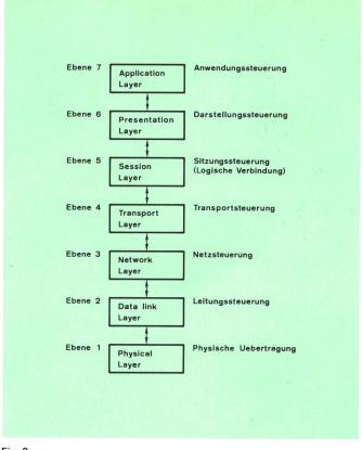
Modello degli strati dell'architettura ISO per «sistemi aperti»
