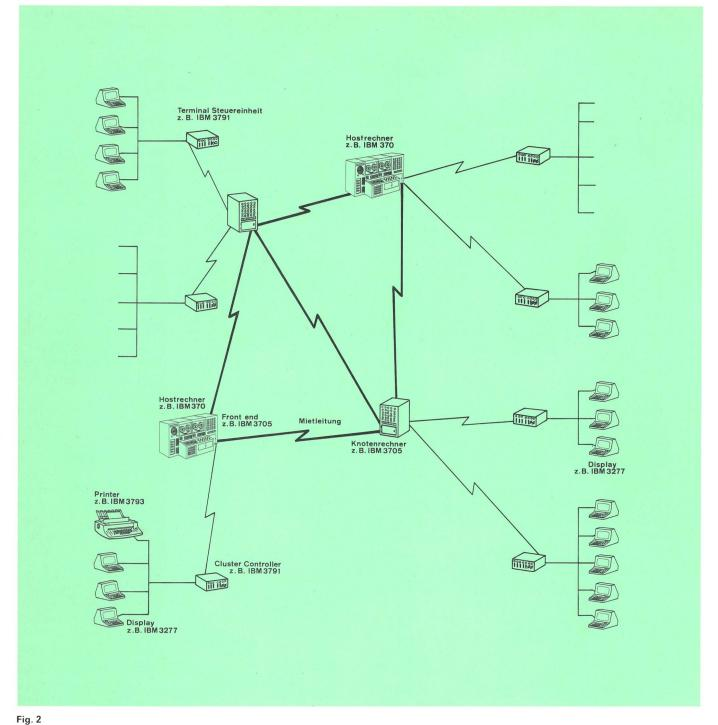
Rete di comutazione dati privata, ad esempio secondo l'architettura della rete SNA dell'IBM
