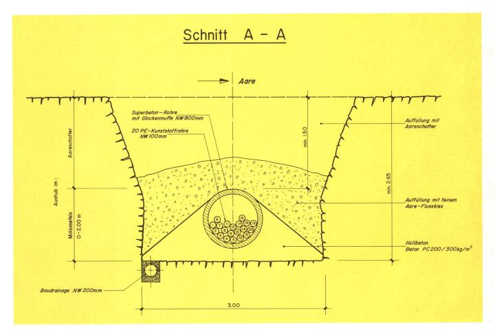
Fig. 4a Querschnitt A—A, Normalprofil im Flussbereich
