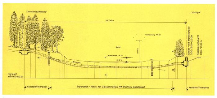
Fig. 2 Längsschnitt der Aareunterquerung
