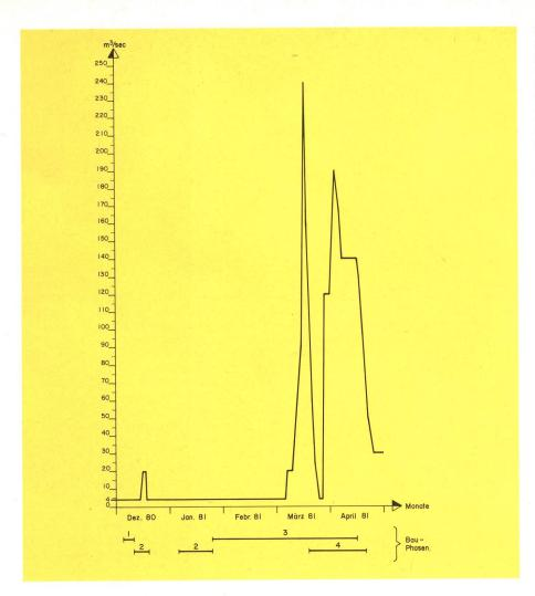
unter anderem die Baugrube des Spleissschachtes während ungefähr drei Tagen überschwemmt (Bauphase 3, Mitte März 1981, Fig. 6). Bei «programmiertem» Hochwasser (Seeschleusenregulierung in Thun, kein Wasserabfluss durch den Stollen Engehalde—Felsenau) wurden Baustelle und Bauleitung durch die Zentrale des Stauwehrs Engehalde telefonisch benachrichtigt. So liessen sich die nötigen Massnahmen jeweils frühzeitig treffen.
