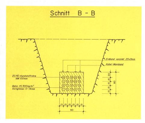
Den nachträglichen Einzug der 20 Kunststoffrohre (Weichpolyäthylenrohre, Durchmesser 100/116 mm) besorgten die Spezialisten des Kabeldienstes (Kabelzug-Gruppe). Die Kabelschutzrohre wurden drei Monate vor Gebrauch in Längen zu 120 m auf die Baustelle geliefert und geradlinig ausgelegt gelagert.
