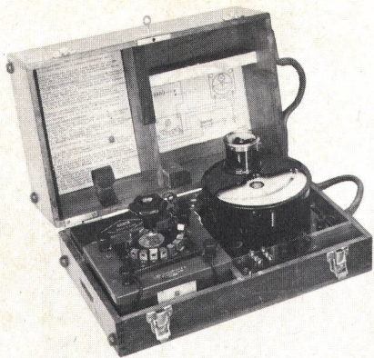
Der 1922 neugeschaffene Messkoffer «Modell 1922» für Isolations- und Kapazitätsmessungen auf Leitungen
