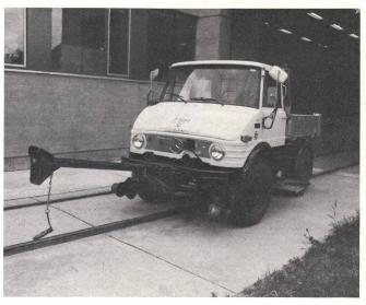
Fig. 6 Unimog als Zweiwegfahrzeug
