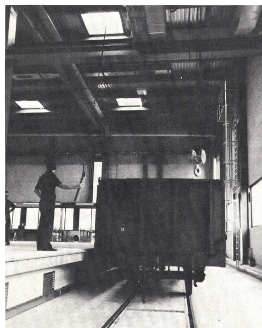
Fig. 9 Äusserste Position des Laufkrans
