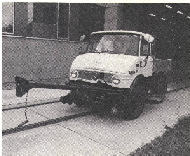
Fig. 6 Unimog als Zweiwegfahrzeug
