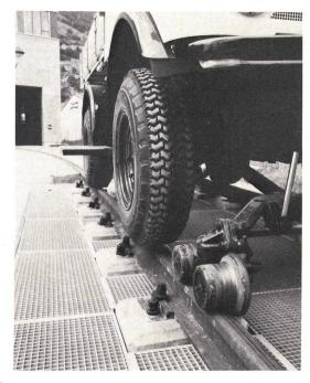
Fig. 7 Schienenführungsrollen
