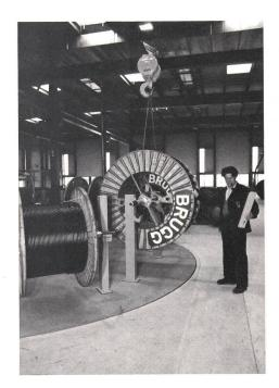
Fig. 12 Drehscheibe mit Kabelhaspeln
