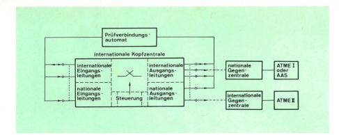
Fig. 1 Beispiel einer Prüfkonfiguration für interkontinentale Zentralen Automatische Test- und Messeinrich-
