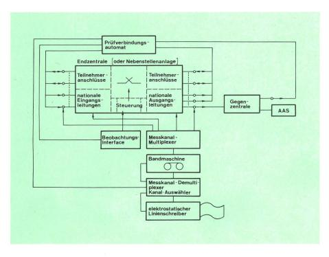
Beispiel einer Prüfkonfiguration für Endzentralen AAS Automatische Antwortstation
