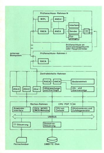
Fig. 3 Hardware-Blockschema des Prüfverbindungsautomaten PA
