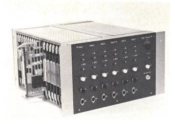
Fig. 5 Ein Prüfanschlussrahmen mit demontiertem Schutzrohrrahmen. Eine Baugruppe Doppeleuropaformat ist etwas herausgezogen
