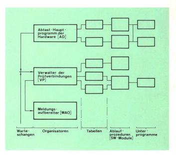
Fig. 7 Struktur der Software SW-Modul — Software-Modul
