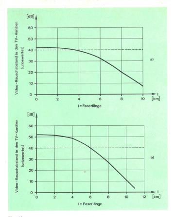
Fig. 10 Gerechnete Videorauschabstände als Funktion der Faserlänge bei der Übertragung von vier TV- und sechs FM-Radiokanälen mit Amplituden- beziehungsweise Frequenzmodulation
