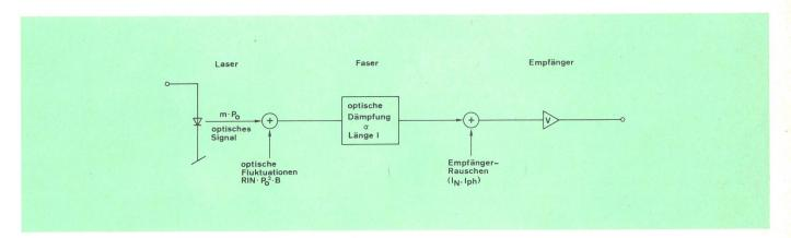
Fig. 11 Übertragungsmodell zur Berechnung des Rauschabstandes bei einer faseroptischen Analogübertragung
