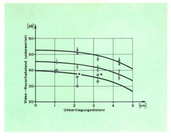
Fig. 5 Videorauschabstand als Funktion der Übertragungsdistanz. Bei der Übertragung von einem oder zwei Kanälen über eine Faser ist der geforderte Rauschabstand von 40 dB erreichbar bis zu einer Entfernung von mindestens 3 km. Verschiedene Punkte einer Sorte entsprechen den Messwerten bei verschiedenen Frequenzlagen der Kanäle.
