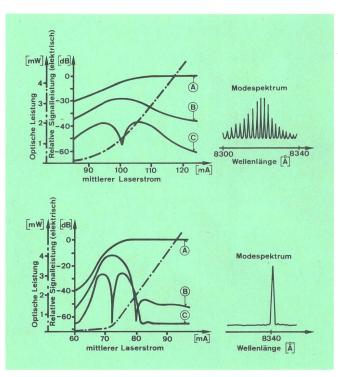
Statische Licht-Strom-Kennlinien, Verzerrungen und Emissionsspektren eines V-Nut- (oben) und eines Channeled-substrate-Lasers (unten). Die Verzerrungen sind mit der 2-Sender-Methode (Anhang B) gemessen. Die Aussteuerung betrug bei beiden Lasern 10 mA peakpeak. Die Intermodulationsverzerrungen zweiter und dritter Ordnung (IM<sub>2</sub> beziehungsweise IM<sub>3</sub>) nehmen im lasenden Betrieb ab und haben bei hohen Arbeitspunktströmen grosse Abstände zum Nutzsignal.
