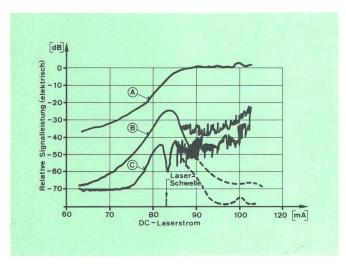
Fig. 9 Einfluss der optischen Rückkopplungen von einer angekoppelten Faser auf die Linearität der Laserstrahlung
