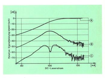
Fig. 3 Intermodulationsverzerrungen des Übertragungssystems mit einem V-Nut-Laser als Sender und einer angekoppelten Gradientenindex-Faser von etwa 3 km Länge (Laseraussteuerung: 7 mA $_{p-p}$ ; emittierte optische Leistung: 3 mW $_{p-p}$ )
