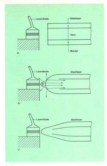
Fig. 2 Faserenden für «butt-joint»-Laser-Faser-Kopplungen a) Glatter Faserschnitt, Lichteinkopplungsgrad  $\approx 35~\%$
