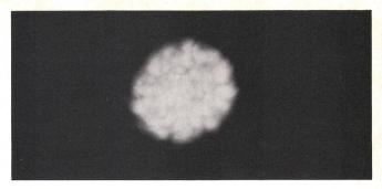
Fig. 7 Interferenzbild (speckle pattern) von Laserlicht am Ende der Faser Verwendeter Laser: CSP Faserlänge: 500 m Kerndurchmesser: 50 µm
