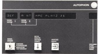
Fig. 7 MPE-Störungsanzeige
