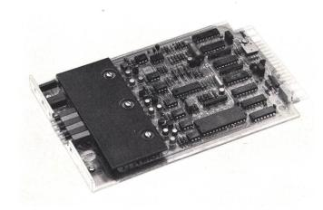
Fig. 3 Zeittaktverstärker ZTV (drei Verstärker auf einer Baugruppe).
