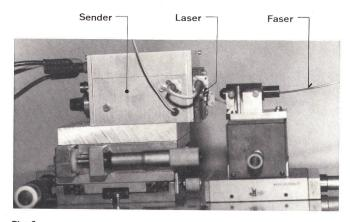
Fig. 6 Sendermodul mit aufgesetzter Diodenhalterung und angekoppelter Faser
