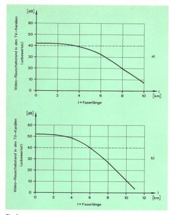
Fig. 4 Gerechnete Videorauschabstände als Funktion der Faserlänge bei der Übertragung von vier TV- und sechs FM-Radiokanälen mit Analog- beziehungsweise Frequenzmodulation
