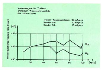
Fig. 9a Verzerrungen der Treiberschaltung, gemessen nach der Zweisendermethode (siehe Anhang A im Schluss), als Funktion der Frequenz des modulierenden Signals; die Signale S<sub>1</sub> und S<sub>2</sub> liegen frequenzmässig 2 MHz auseinander
