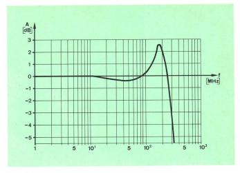
Fig. 13 Frequenzgang des optischen Empfängers nach Figur 12b
