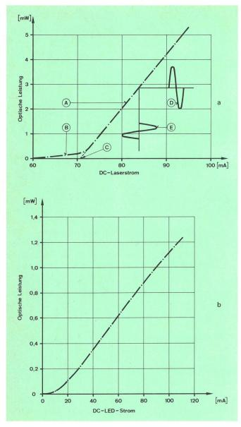
Fig. 2 DC-Lichtstromcharakteristik von lichtemittierenden GaAlAs-Halbleiterdioden
