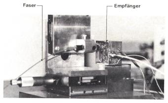
Fig. 10 Optischer Empfänger mit angekoppelter Faser
