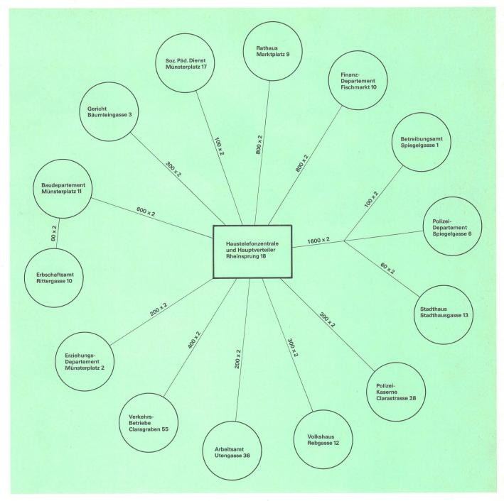
Fig. 2 Zweigkabelanlage
