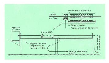
Fig. 3 Place de mesure avec la pince MDS, 30...1000 MHz
