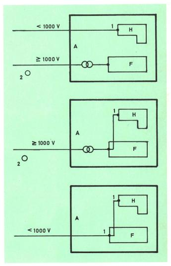
Fig. 4 Usine avec appareil ISM; emplacement des points de mesure pour le contrôle des perturbations produites sur le réseau d'alimentation
