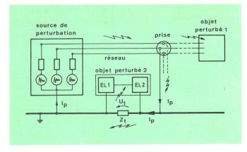
Fig. 5 Perturbations transmises par conduction
