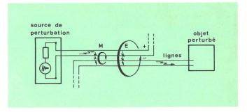
Fig. 6 Couplage par des champs rapprochés électriques et magnétiques
