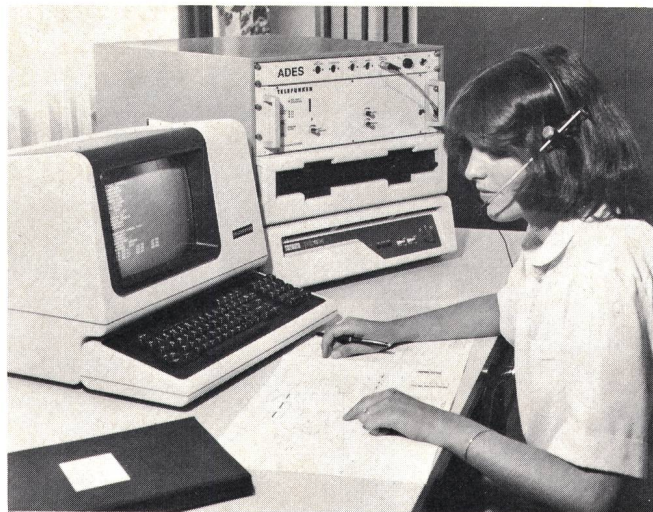
Fig. 10 Einsatz des akustischen Datenerfassungssystems ADES bei der Aufnahme komplexer Datenlisten mit akustischer Rückmeldung und Anzeige auf dem Display
