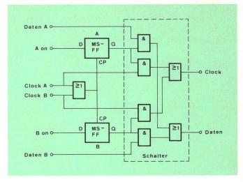
Fig. 3 Blockschaltbild des Umschalters MS-FF Master Slave Flip-Flop **Taktimpuls**
