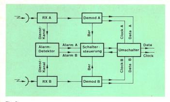
Fig. 2 Blockschaltbild einer 1+1-redundanten Empfangsseite mit Umschal-
