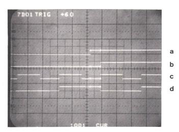
Fig. 4 Zeitlicher Verlauf eines Umschaltvorganges mit Datenwechsel
