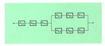
Fig. 1 Verfügbarkeitsblockdiagramm einer 1+1-redundanten Richtstrahlverbindung
