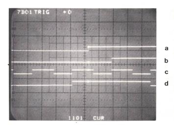
Fig. 5 Zeitlicher Verlauf eines Umschaltvorganges ohne Datenwechsel Umschaltbefehl
