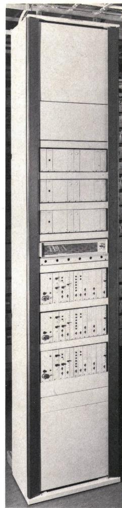
b) Utilisation des points d'accès découplés propres à l'équipement terminal de ligne à 12 MHz de Philips SA (PAG)
