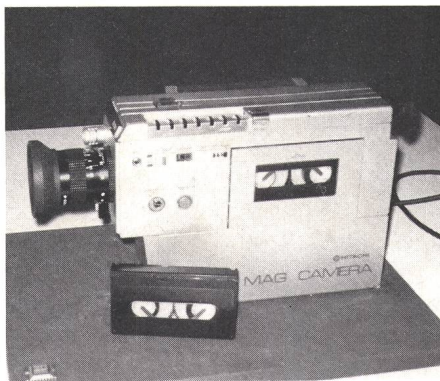
Fig. 16 Videokamera mit integriertem Videorecorder und elektronischem Sucher. Die verwendete Kassette ist nur wenig grösser als die heute millionenfach verwendete Compactcassette, bei allerdings doppelt so breitem Metallband. Vorne links der 8,5 x 10 mm grosse Bildsensor-Chip
