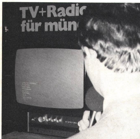
Fig. 20 Sprachgesteuerter TV- und Radio-Empfänger. Auf dem Bildschirm erscheinen die für jeden Befehlsgang möglichen Einzelbefehle
