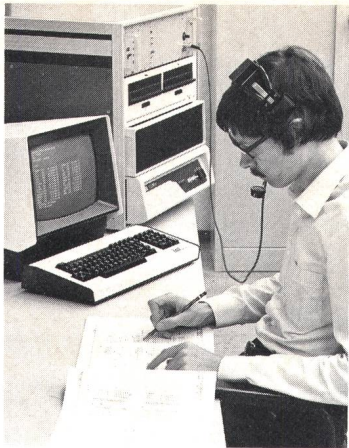
Fig. 11 Anwendung der akustischen Datenerfassung (ADES) beim Erstellen von Verdrahtungslisten aus Stromlaufplänen. Mit ADES wird dieser Ablauf stark vereinfacht, weil der Bearbeiter die aus dem Stromlaufplan gelesenen Daten direkt in den Computer eingeben kann. Eine Sprachausgabe als akustische Rückmeldung und die Anzeige auf einem Display dienen der Kontrolle
