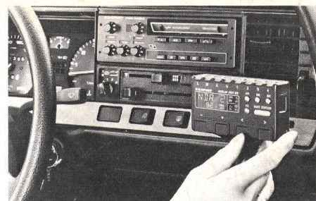
Fig. 7 Dieser Autoradio zeigt nicht nur die Frequenz des empfangenen Senders und dessen Programm an, er sagt dieses gleich auch noch mit synthetischer Stimme an (Werkfoto: Blaupunkt)
