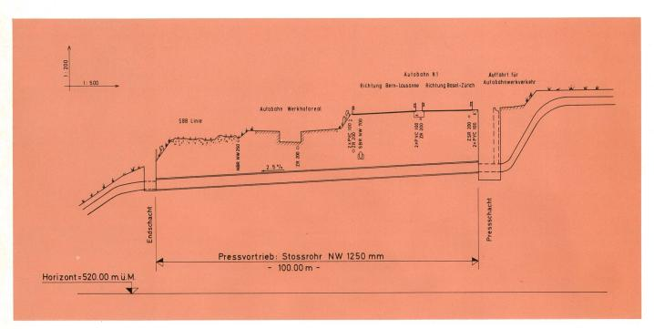
Fig. 1 Längsschnitt durch das Pressrohr. Die Stossrichtung erfolgte im Gefälle, weil der Pressschacht aus Gründen der Zugänglichkeit in der Auffahrt für den Autobahnwerkverkehr sein musste
