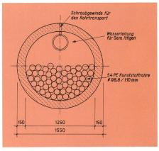
Fig. 3 Querschnitt durch das Pressrohr. Die Druckwasserleitung wurde im vorhandenen Gewinde für den Rohrtransport im Scheitel des Pressrohres mit einer besonderen Aufhängung befestigt
