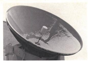
Fig. 8 Tauender Schnee in der OTS-Empfangsantenne am 3. April 1979, 0740 Uhr
