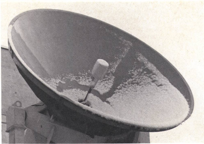
Fig. 8 Tauender Schnee in der OTS-Empfangsantenne am 3. April 1979, 0740 Uhr
