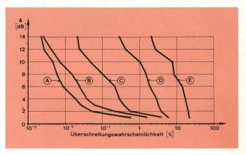
Fig. 1 Summenhäufigkeitsverteilung der Dämpfung bei 11,6-GHz-Satellitenverbindungen
