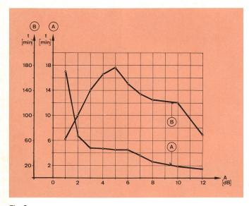
Fig. 3 Mittlere Dauer der Dämpfungsereignisse, Mittelwert der Ereignisse von Juni 1978 bis Dezember 1979
