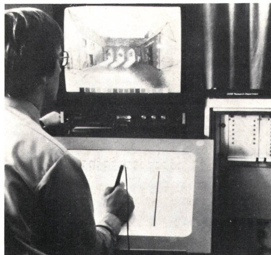
Fig. 9 «Boîte de coloriage vidéo», équivalent électronique du pinceau, de la plume et des couleurs utilisés par les graphistes et permettant d'introduire directement des croquis coloriés dans un système de télévision, passer par la prise de vue d'un original sur papier
