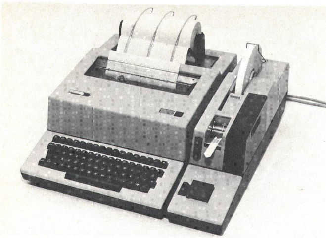
Fig. 2. Fernschreiber Hasler SP 300 ASR oder MSR 8-T/16-T, die sich äusserlich nicht unterscheiden. Der elektronische Meldungsspeicher ist in der Tastatureinheit eingebaut — Téléimprimeur Hasler SP 300 ASR ou MSR 8-T/16-T (extérieurement, les deux modèles ont le même aspect). La mémoire électronique de messages est incorporée dans l'unité du clavier
