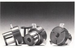
Oft liegt die Hauptanforderung bei einem Kontaktsystem in der Verschleissfestigkeit. Das ist der Fall bei bewegten Kontakten, vorzugsweise aber bei rotierenden Apparateteilen; z.B. Kollektoren von Kleinstmotoren. Unsere ternäre Goldlegierung GALVATRONIC® mit einer Mikrohärte von 400 HK erfüllt diese Forderung optimal, ohne dass in bezug auf die übrigen Vorteile von Goldschichten Abstriche gemacht werden müssten.
