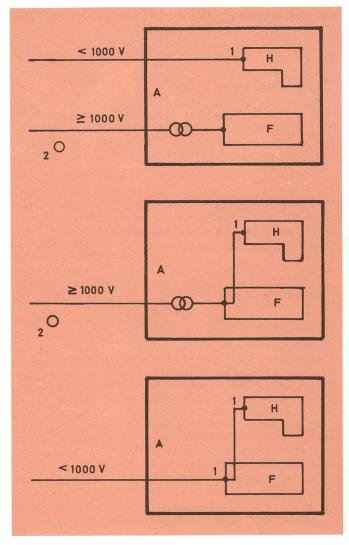
Fig. 4 Fabrikareal mit ISM-Gerät. Anordnung der Messpunkte für die Kontrolle der auf dem Speisenetz geleiteten Störungen
