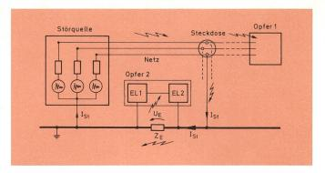
Fig. 5 Leitergebundene galvanische Kopplung der Störung Opfer 1 wird direkt durch die Netzleitungen beeinflusst
