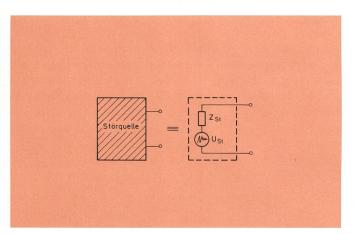
Fig. 4 Ersatzstörquelle U<sub>St</sub> Störquellenspannung
