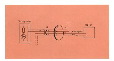
Kopplung durch elektrische und magnetische Nahfelder M Magnetisches Feld E Elektrisches Feld ✓ Störsignal
